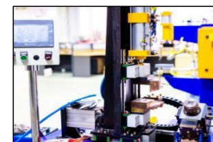
Fan blade automatic welding machine
